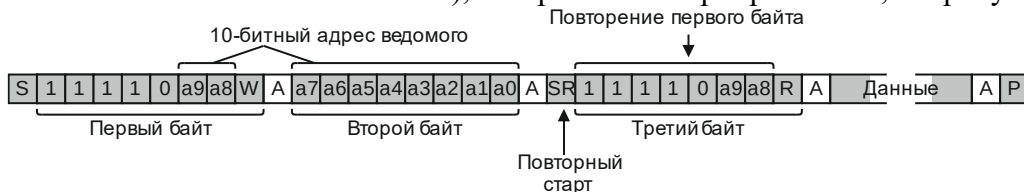
Рисунок 27.11 – Получение данных от ведомого с 10-битным адресом
