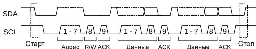
Рисунок 27.8 – Передача данных с 7-битной адресацией
