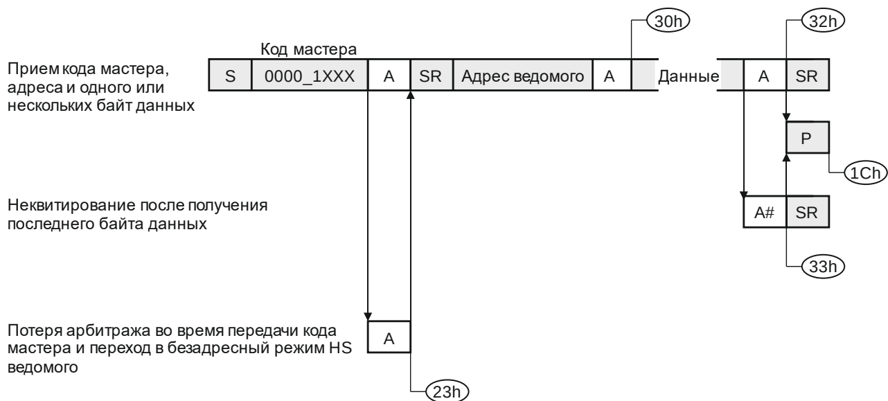
Рисунок 27.21 – Режим HS ведомого приемника
