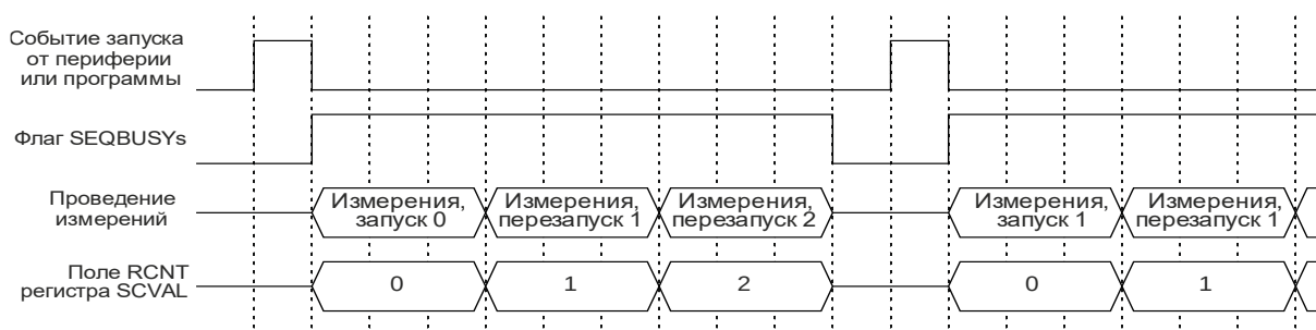
Рисунок 21.4 – Диаграммы работы секвенсора при одиночных запусках по событиям с немедленными перезапусками при RCNT = 2 (регистр SCCTL)
