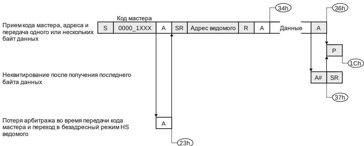
Рисунок 27.23 – Режим HS ведомого передатчика
