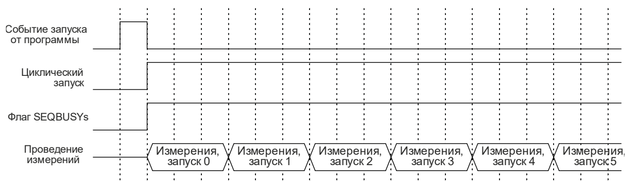
Рисунок 21.7 – Диаграммы работы секвенсора при циклическом запуске
