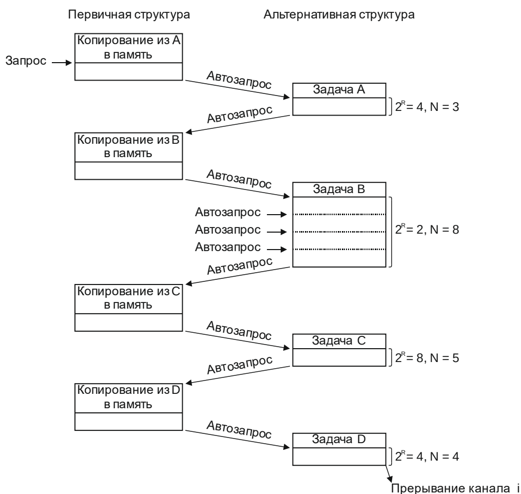
Рисунок 10.4 – Пример функционирования контроллера DMA в режиме «разборка-сборка»
