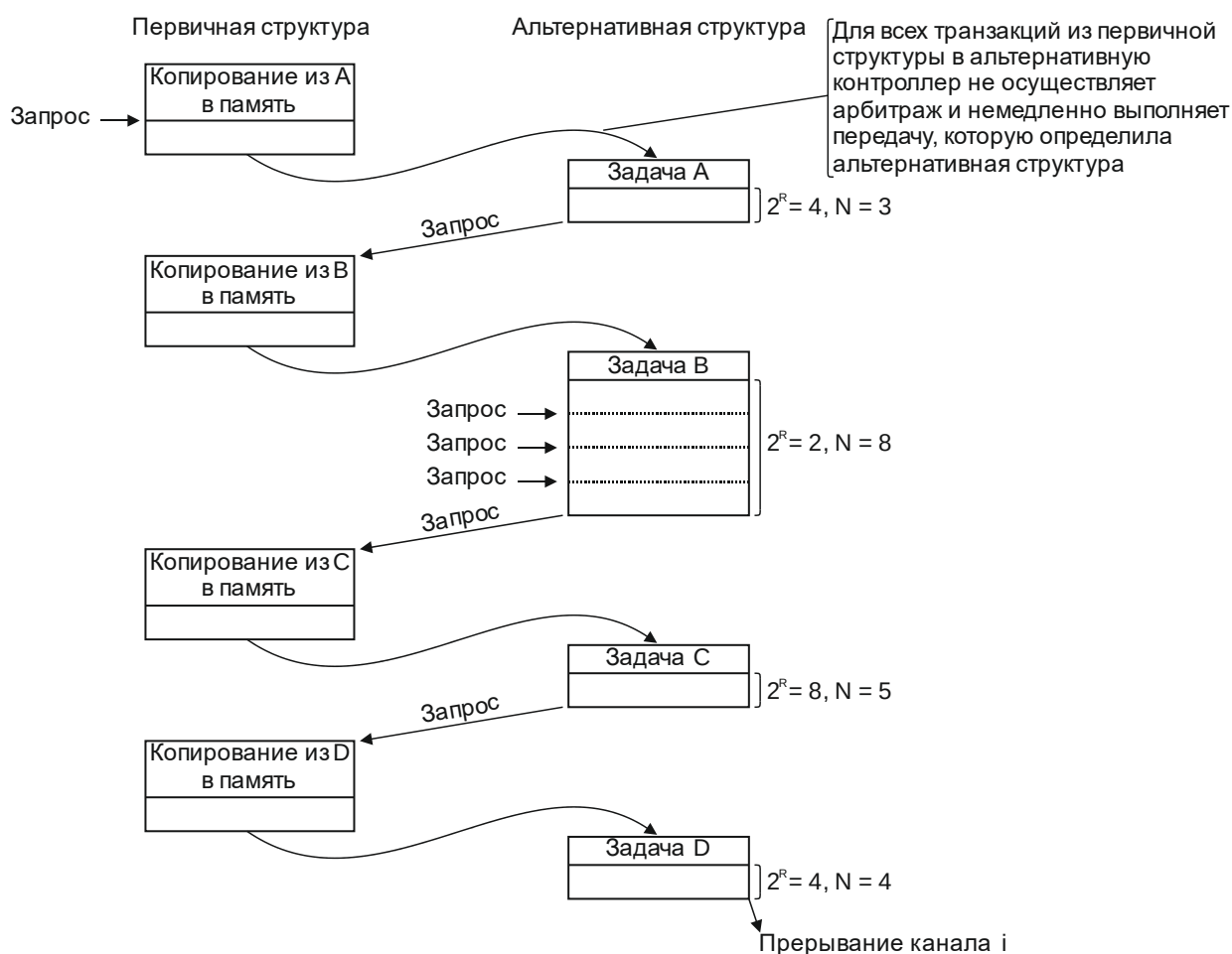
Рисунок 10.5 – Пример функционирования контроллера DMA в режиме работы с периферией «разборка-сборка»
