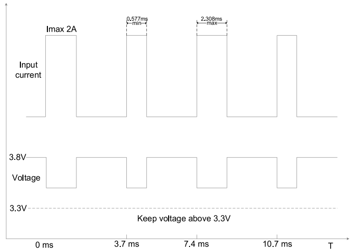
Рисунок 1. Потребление тока в режиме передачи GPRS и типовые допустимые провалы питающего напряжения
