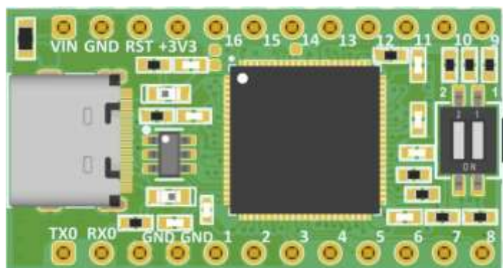
Рисунок 9-1 3D модель платы EVU-LI
