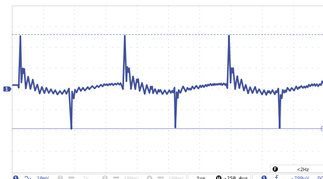
Рис. 7 (в). Осциллограмма пульсаций выходного напряжения.
