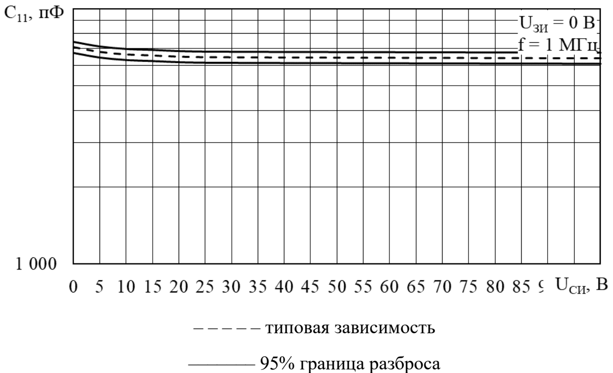
Рисунок Ж.46 – Область изменения входной емкости в зависимости от напряжения сток-исток КП7273В9 при температуре корпуса t_{кор} = (25 \pm 10) \text{ }^\circ\text{C}
