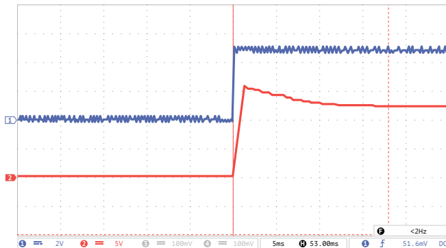
Рис. 17. Осциллограмма установления выходного напряжения с момента подачи команды дистанционного управления.
